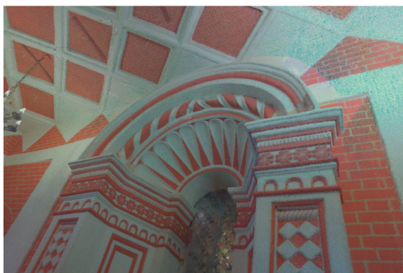
Облако точек, полученное с помощью лазерного сканнера
